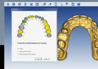
Escaneamento do modelo por meio de projecção de feixe de luz. Até 8 elementos podem ser gravados por escaneamento utilizando a „Estratégia de escaneamento inteligente” (Intelligent Scan Strategy - ISS).
