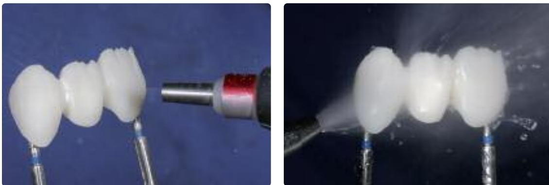
Jatear a restauração com  $\text{Al}_2\text{O}_3$  (Tipo 100) e 1 bar (15 psi) de pressão. Antes da queima de "wash", limpar completamente a superfície com um jato de vapor e, a seguir, secar.
