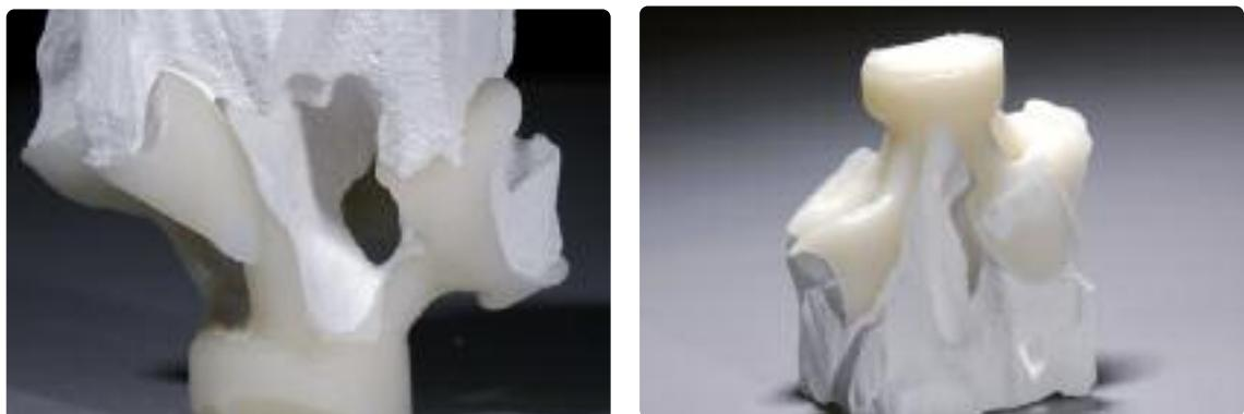
A remoção final do revestimento é realizada com pérolas de vidro para polimento e 2 bar (30 psi) de pressão.
