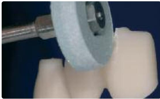
Alisar os pontos de conexão dos "sprues", usando leve pressão e baixa velocidade.
