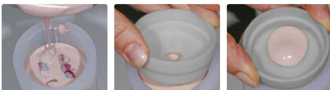
Usar o IPS Silicone Ring para a inclusão. De modo lento e cuidadoso, preencher com o revestimento até a marcação e posicionar o IPS Ring Gauge com um movimento giratório.
