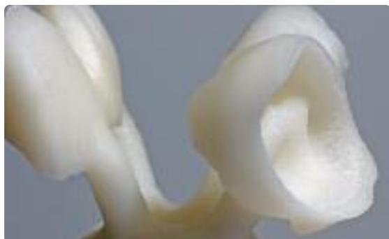
Remover a camada de reação, formada sobre os objetos injetados, usando o Invex Liquid em banho de ultra-som.
