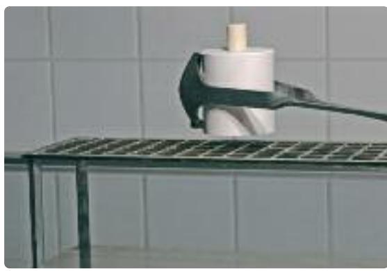
Terminado o programa de injeção, colocar, com o auxílio de pinças de revestimento, o anel de revestimento sobre a grade de esfriamento e deixar esfriar até a temperatura ambiente.
